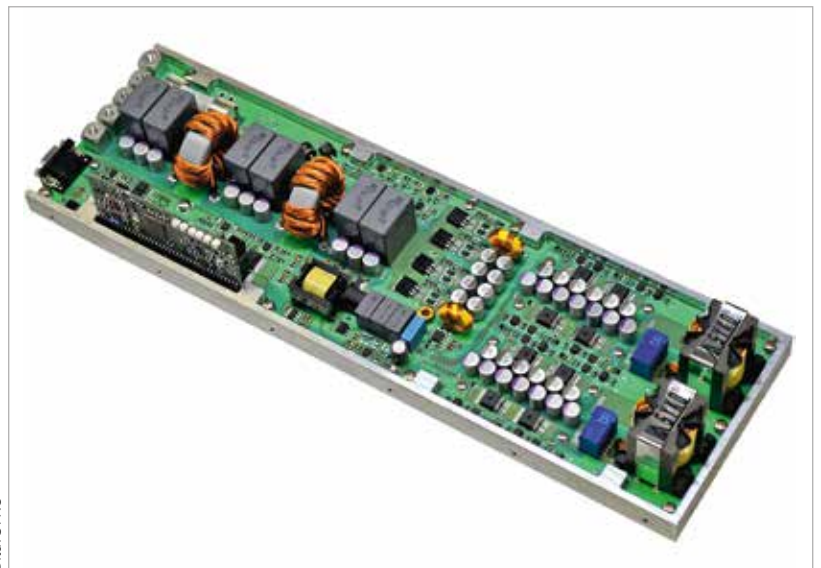
Bild 2: Mit dem 1.000-Watt-Buck-Boost-Wandler CLW lassen sich Kondensatorbatterien an Bordnetzen im Spannungsbereich 9 bis 36 V laden.
